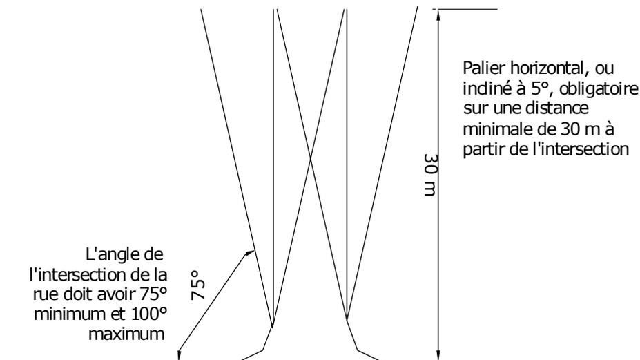
2 intersections de 2 voies locales et d'une troisième voie locale ou d'une collectrice doivent être espacées d'au moins 60 mètres. Les mesures doivent être prises en centre par rapport à l'emprise.
